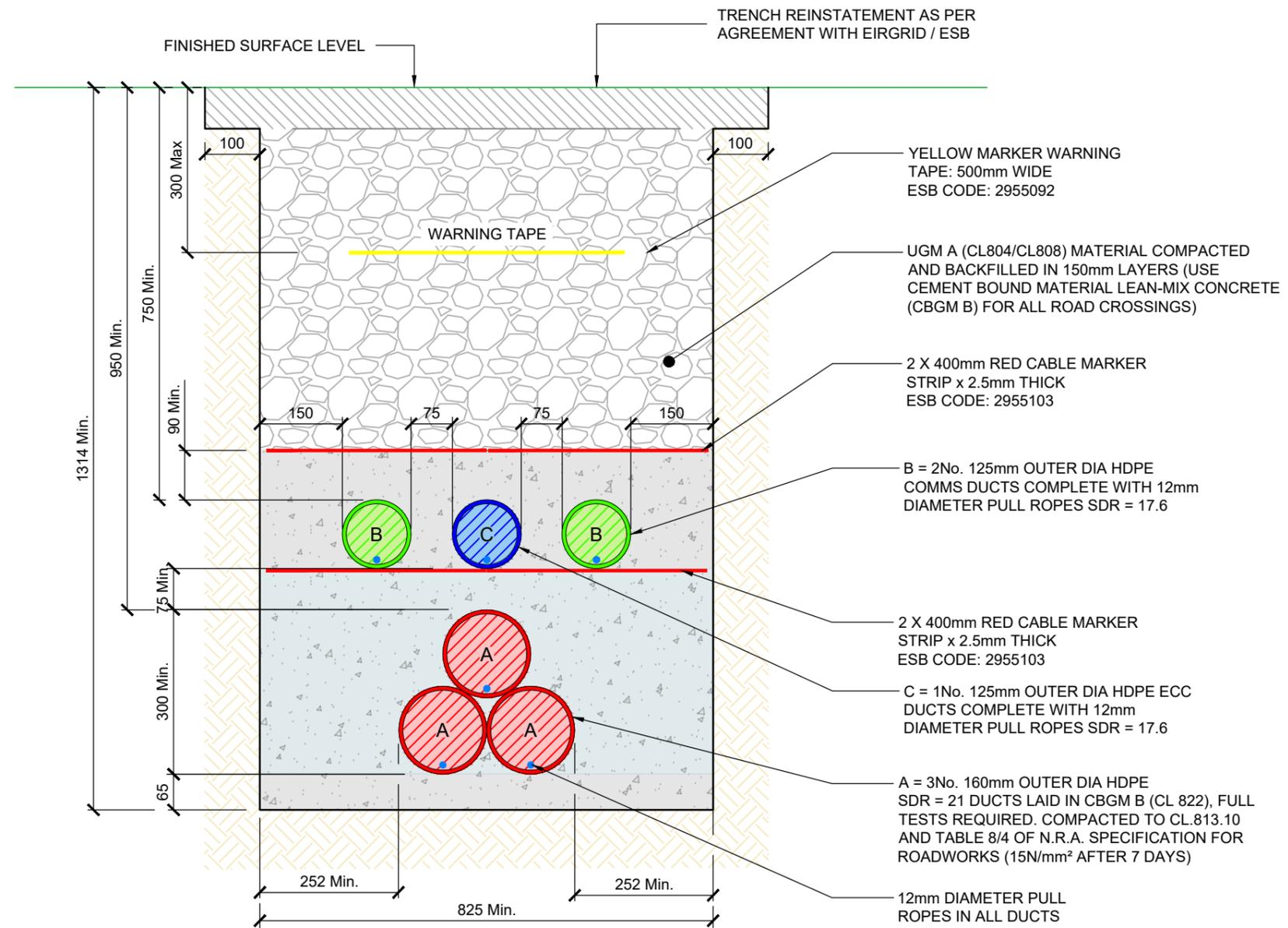
**TYPICAL 110KV CABLE TRENCH DETAIL**
